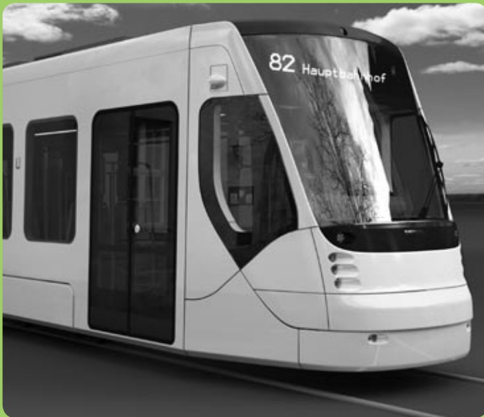
En nyutvecklad spårvagn av rostfritt stål för stadstrafik.
